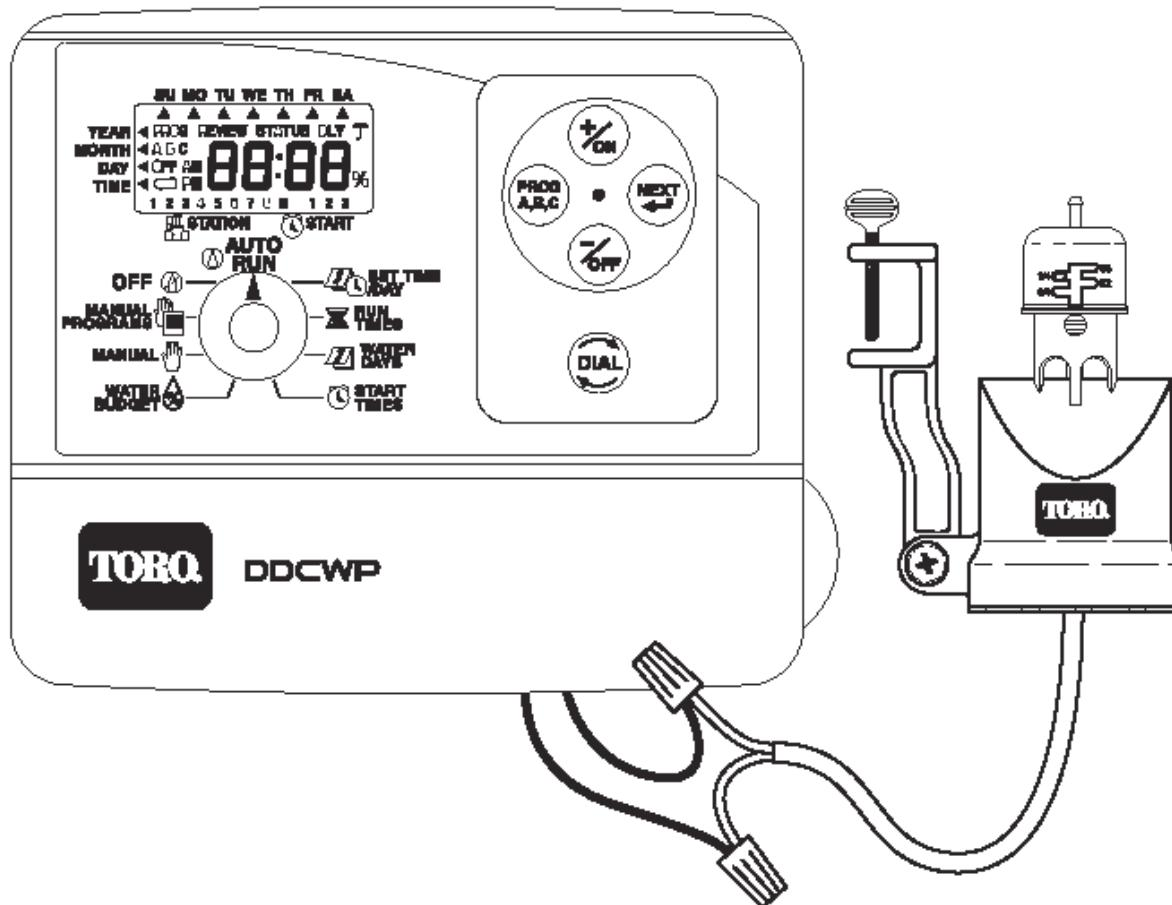
Za DDCWP će odgovarati TRS senzor za kišu. Treba preseći žutu kratko spojenu žicu od upravljačke jedinice pomoću vodonepropusnih spojnica i spojiti krajeve presećene žute žice i krajeve žice od senzora za kišu.
