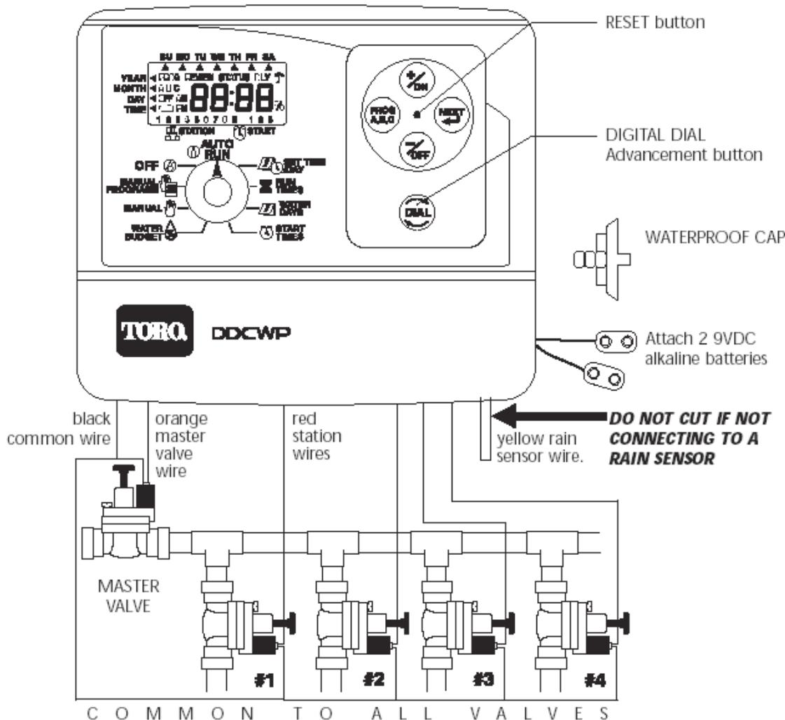
Nakon spajanja žica uklonite vodonepropusni zatvarač prostora za smeštaj baterija, i obe 9VDC utičnice za baterije.
