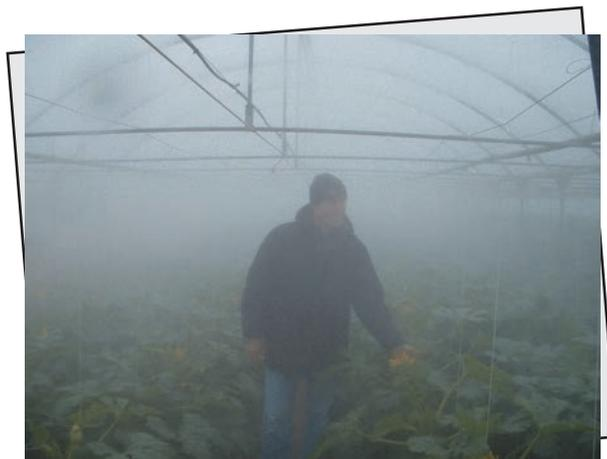
L'impianto di nebulizzazione TecnoCooling funziona ad una pressione di 70 BAR trasformando l'acqua in micro-gocce di circa 10 micron di diametro che, per la loro piccolissima dimensione, rimangono a lungo sospese nell'aria producendo l'effetto nebbia.
